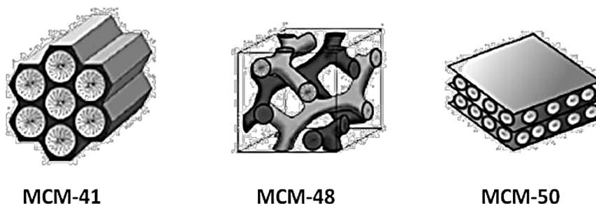
Figura 1. Estructuras mesoporosas de la familia de materiales M41S: MCM-41 (2D hexagonal,  $p6mm$ ), MCM-48 (cúbica,  $la3d$ ) y MCM-50 (laminar,  $p2$ ).
