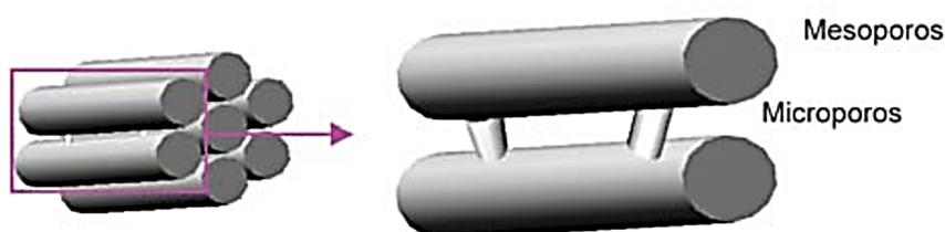
Figura 2. Esquema ilustrativo del sistema poroso en SBA-15.
