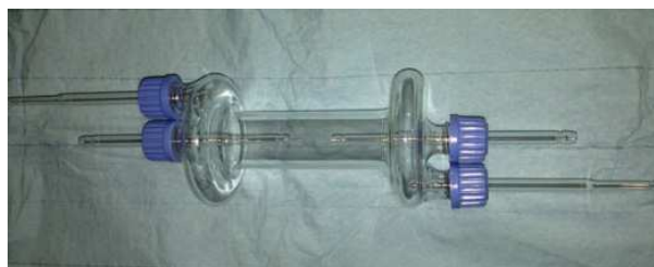
Figura 8. Biorreactor con dos cámaras de cultivo desarrollado por Crowley C, Birchall M, Seifalian AM (3).
