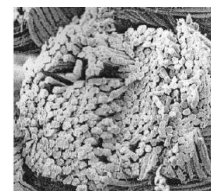
Figura 13: Corte transversal de una sutura biodegradable de PLA (32)
