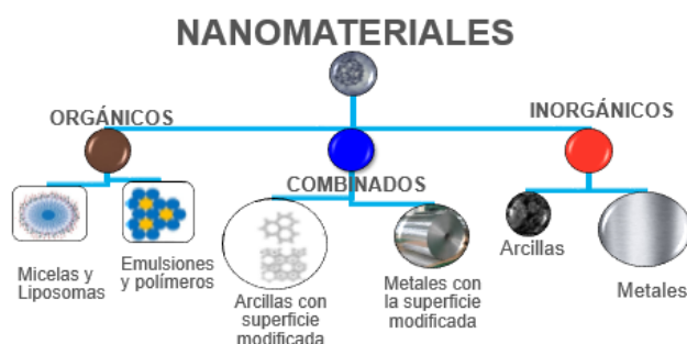
Figura 1: Esquema de los tipos de nanomateriales utilizados para recipientes utilizados en contacto con alimentos(5).
