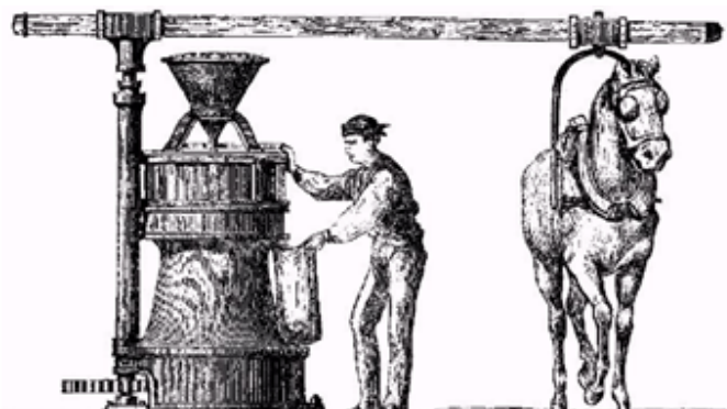
Figura 2: Molino rural movido por caballería 18 .
