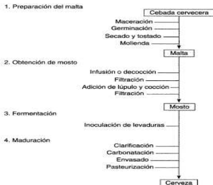
Figura 1 Proceso de elaboración de la cerveza
