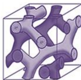
Figura 2: representación esquemática de MCM-48. Estructura tridimensional.
