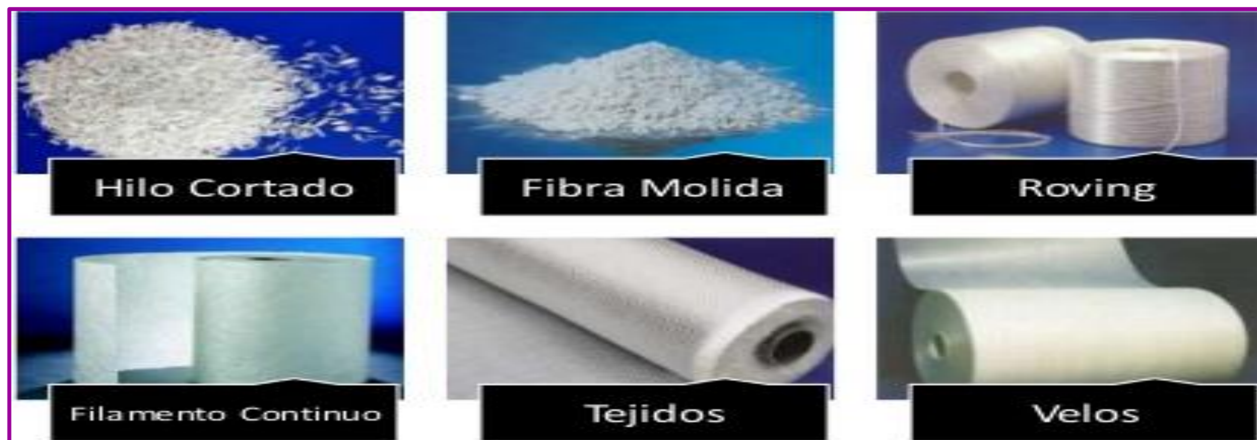
Figura 4. Formas comerciales de la fibra de vidrio.
